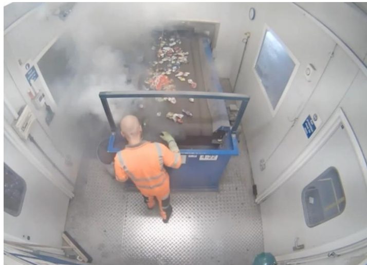
Fumée toxique projetée sous pression par une batterie au lithium SOURCE : BBC News.
