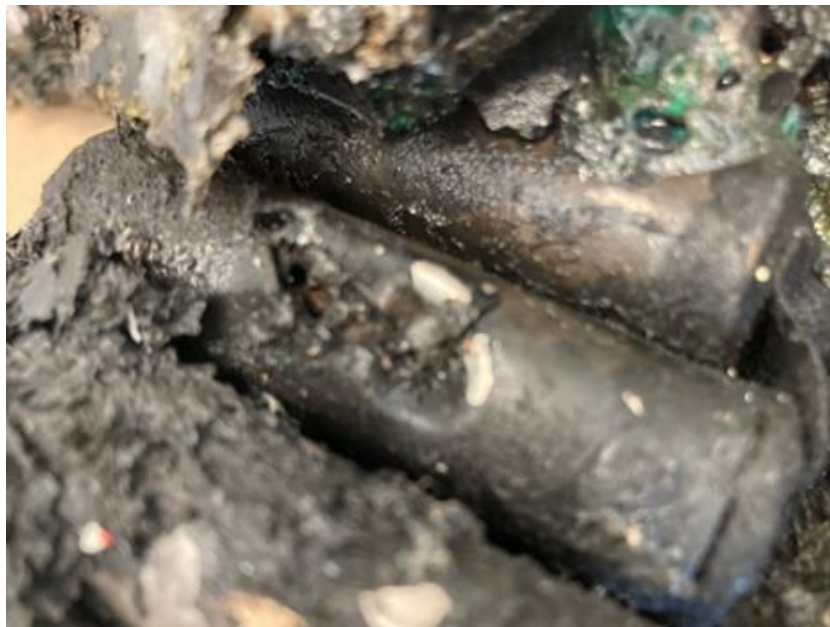
SOURCE : Piles au lithium percées dans le procédé Ricova, résultant en un incendie au centre de tri de Lachine, le 2 juin 2021.
