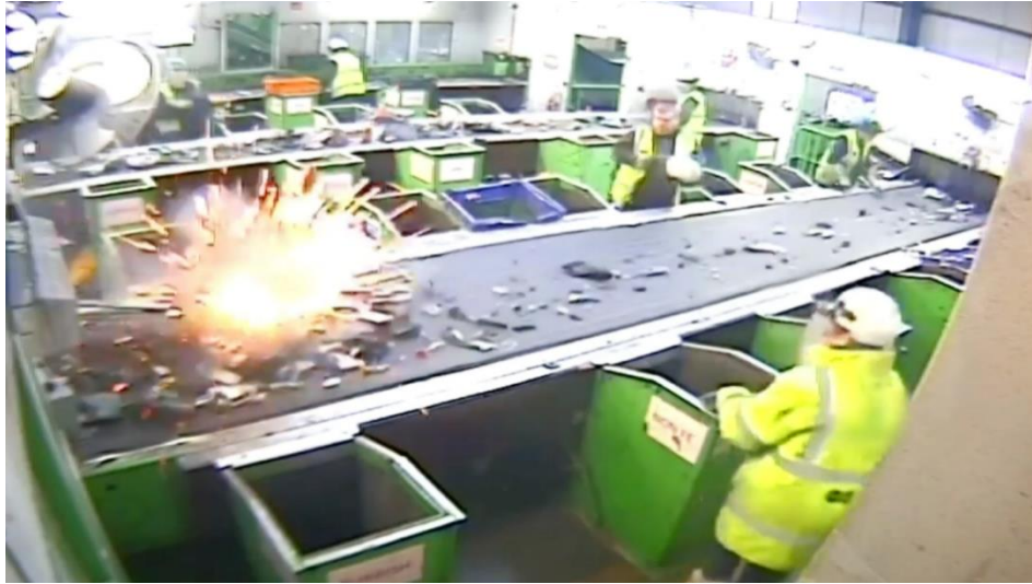
Explosion d'une pile au lithium endommagée dans le procédé SOURCE : BBC News.
